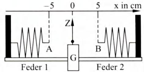
Der Punkt A der Feder 1 besitzt die Koordinate  $x_A = -5,0 \text{ cm}$ ; der Punkt B der Feder 2 die Koordinate  $x_B = 5,0 \text{ cm}$ . Die anderen Enden der beiden Federn sind gemäß Skizze befestigt. Die beiden Federn werden gedehnt und ihre freien Enden am Zeiger befestigt. Die am Gleiter angreifenden Kräfte halten sich das Gleichgewicht. In dieser Gleichgewichtslage ist der Zeiger Z zum Nullpunkt 0 der x-Achse gerichtet.
